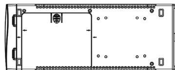
На крышке батарейного отсека имеется круглая кнопка. Необходимо нажать кнопку и затем выдвинуть крышку, пока стрелки на крышке не выровняются со стрелками на ИБП, после чего крышку можно снять.
