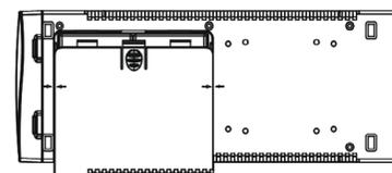
После снятия крышки, необходимо извлечь АКБ, затем отсоединить провода от положительной и отрицательной клемм.
