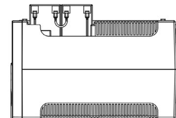
Возьмите новый АКБ затем подсоедините к положительной и отрицательной клемме АКБ, не перепутайте полярность, это может привести к повреждению АКБ. Если при подсоединении проводов и клемм возникнет искра, не пугайтесь это нормально.
