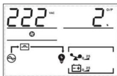
ЖК-дисплей 8: количество подключенной батареи
